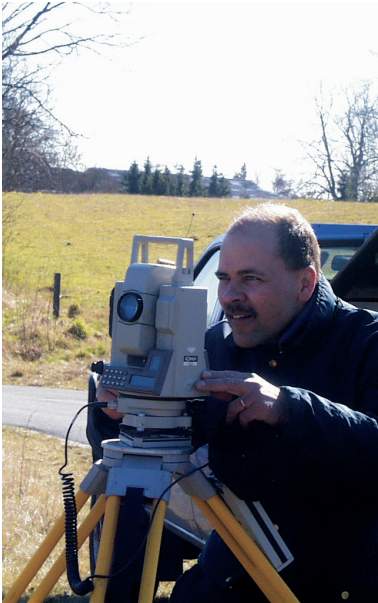
En landinspektør arbejder med sin teodolit. Til højre ses et fikspunkt til fastlæggelse af højde
